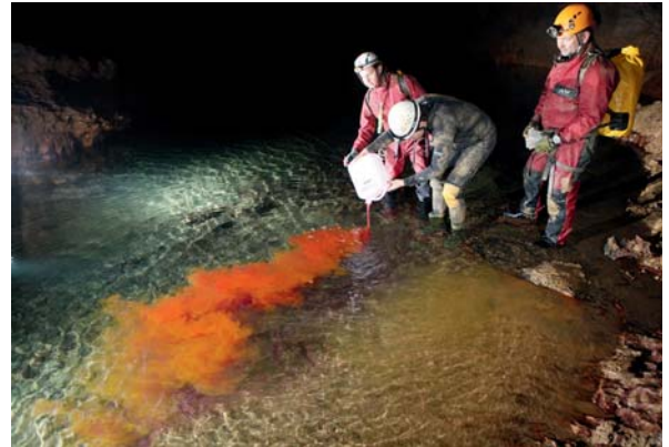
Bild 1. Eingabe eines ungiftigen Fluoreszenzfarbstoffs ins Blauhöhlensystem bei Blaubeuren. Durch Markierungsversuche können die unterirdischen Fließwege des Grundwassers erkundet und die Ausbreitung von Schadstoffen experimentell simuliert werden. © Andreas Kücha
