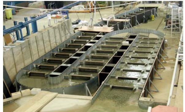
Bild 1. Physikalisches Modell der FAA Geesthacht zur Detailoptimierung. © IWG
