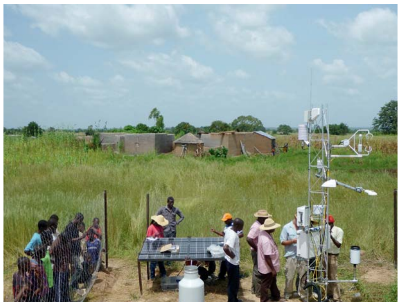
Untersuchung von Landoberfläche-Atmosphäre-Wechselwirkungen in Westafrika: Aufbau von hydrometeorologischer Messinfrastruktur in Ghana (BMBF WASCAL). © Kunstmann
