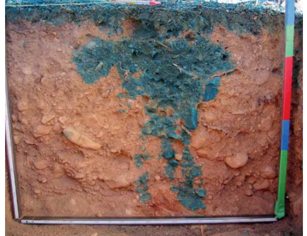
Bild 6. Grundlagenforschung: Beregnungsversuche mit Farbtracern für hydrologische Prozessstudien.
