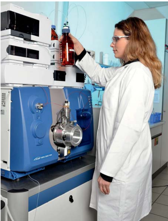
Bild 1. Das TZW verfügt über modernste Analysensysteme zur Bestimmung von chemischen Verbindungen im Spurenbereich – hier für den Nachweis von Arzneimittelrückständen in Wasser. © TZW
